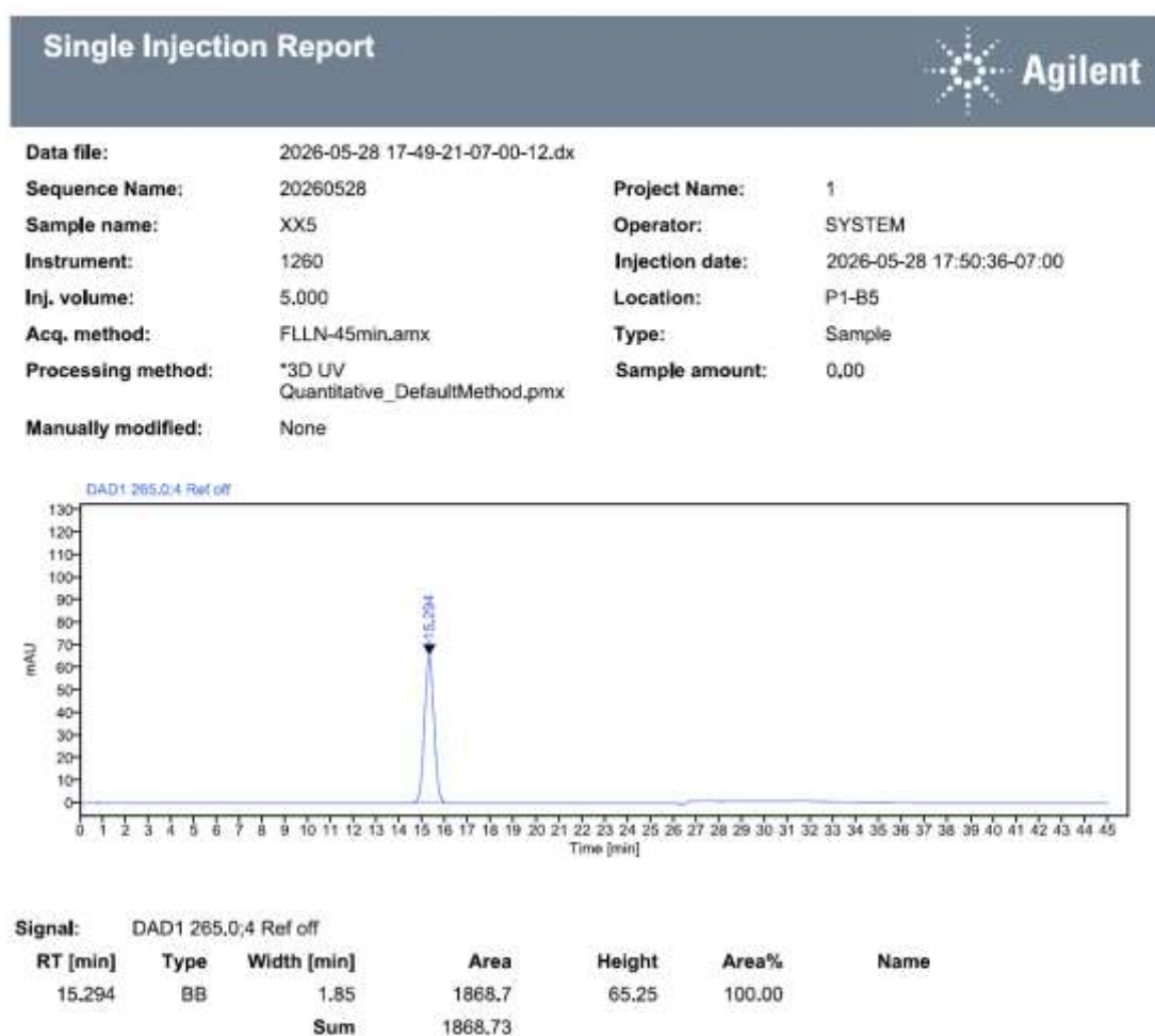
图9 氟雷拉纳线性溶液 Lin-5 高效液相色谱图
