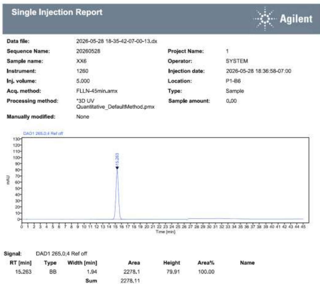
图10 氟雷拉纳线性溶液 Lin-6 高效液相色谱图
