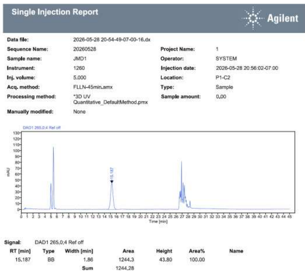
图12 1.8%阿维菌素乳油精密度溶液 P-1 高效液相色谱图
